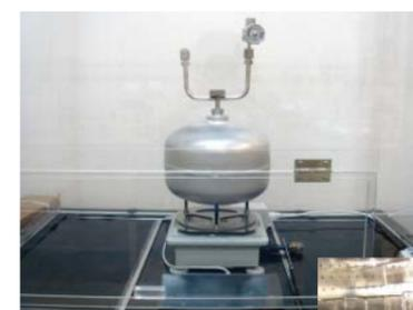
N<sub>2</sub>ガス流量基準器
