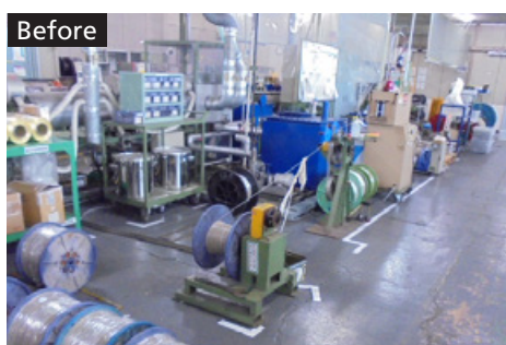
機器用電線巻き替えライン
