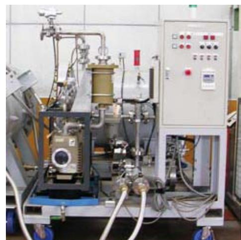
移動式SF<sub>6</sub>ガス回収装置
