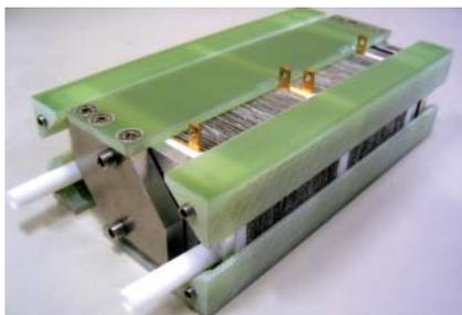
金属セパレータを用いたDMFC
