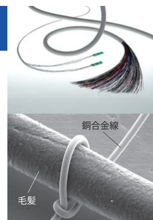
(上)医療用プローブケーブル (下)直径10 \mu mの銅合金線(先端開発品)と毛髪
